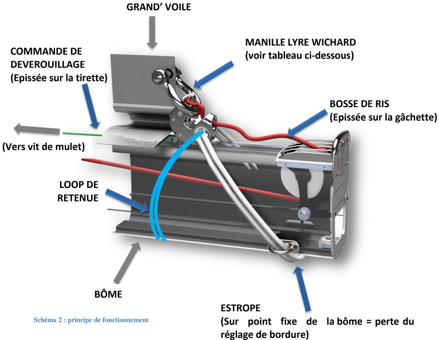
Schéma 2 : principe de fonctionnement
